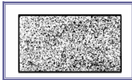
รูปที่ ง.2 สีเป็นเม็ดเนื่องจากการพ่นห่างเกินไป จำเป็นต้องขัดกระดาษทราย
