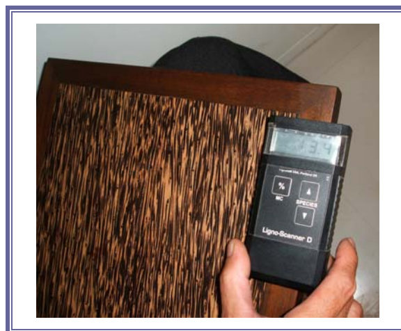
รูปที่ ก.4 เครื่องมือวัดปริมาณความชื้นของเนื้อไม้
