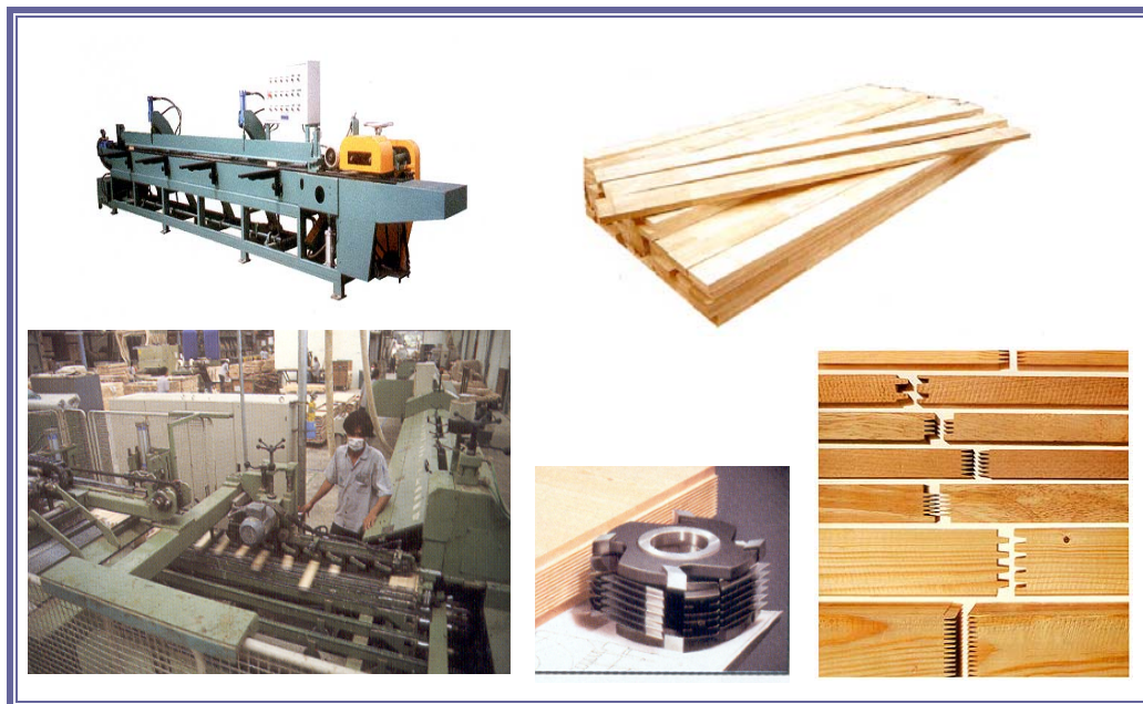
รูปที่ ก.11 เครื่องตีฟัน (Finger Joint Shaper Machine) และภาพตัวอย่างไม้ซิ่นรูปแบบต่างๆ ของข้อต่อแบบนิ้วประสานไม้ที่ผ่านการต่อ-อัดด้วยกาวแล้ว
