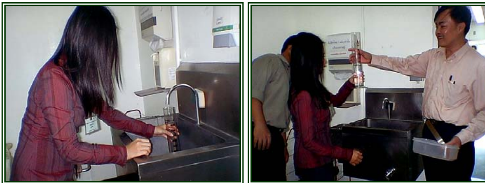
รูปที่ 3-9 การตรวจวัดอัตราการไหลของน้ำ
