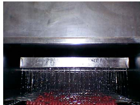
รูปที่ 3-10 ลักษณะเครื่องลดอุณหภูมิไส้กรอก (Chiller) แบบถาดเจาะรู
