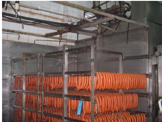
รูปที่ 3-11 ลักษณะเครื่องลดอุณหภูมิไส้กรอก (Chiller) แบบก้านหมุนด้านบน
