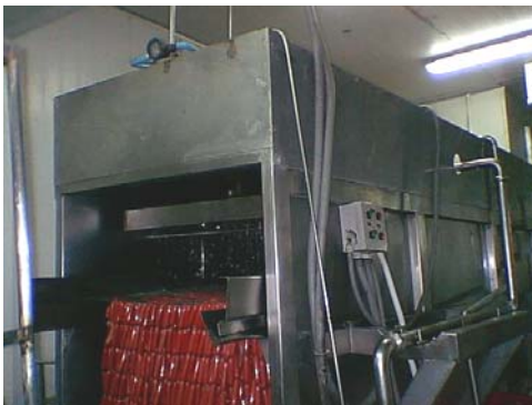
รูปที่ 3-10 ลักษณะเครื่องลดอุณหภูมิไส้กรอก (Chiller) แบบถาดเจาะรู
