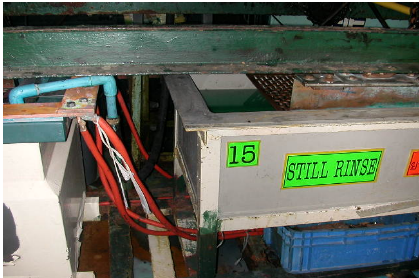
รูปที่ 1.4 ขั้นตอนการล้างแบบจุ่มด้วยระบบอัตโนมัติ (Automatic)
