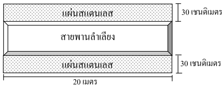
รูปที่ 3-4 การติดตั้งถาดแผ่นสแตนเลสเพื่อรวมน้ำสับประรด
