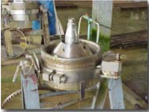
รูปที่ ข2 ด้านในของเครื่องปั่นแยกน้ำยางข้น (Centrifuge)
