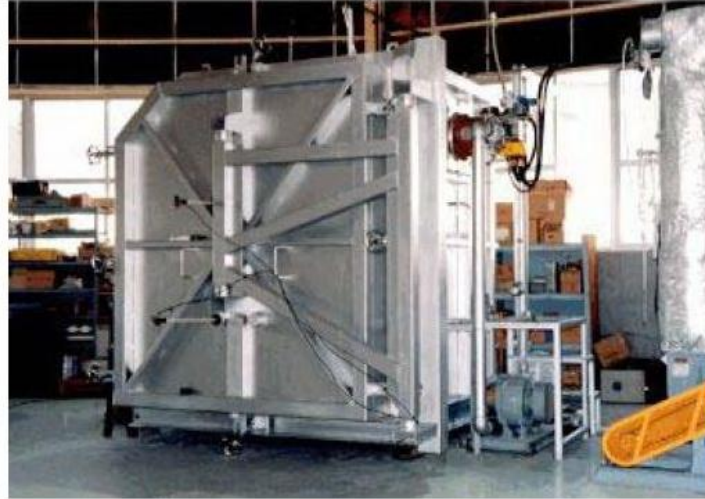
รูปที่ ๒-๑ ภาพแสดงการติดตั้งหัวเผาไร้เงินเนอเรทฟกับเตาเผา
