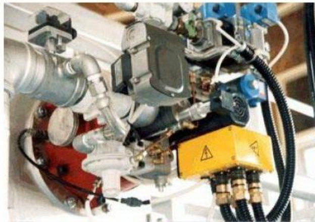
รูปที่ ๒-๒ รูปขยายหัวเผาไร้เงินเนอเรทฟที่ติดกับเตาเผา
