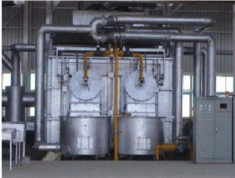
รูปที่ ๒-๓ การติดตั้งหัวเผาแบบรีเจนเนอเรทีฟสำหรับเตาหลอมอลูมิเนียม
