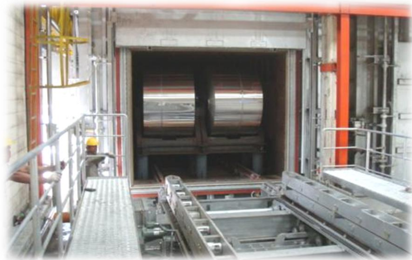
รูปที่ ๓-๓ แสดงภาพการทำงานของเตาอบ (Annealing Furnace)
