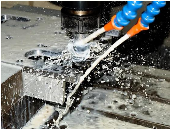
การใช้น้ำมาผสมน้ำมันตัดเหล็ก (ก่อนการดำเนินการแผนงาน)
