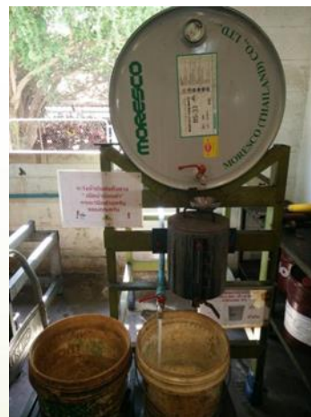
การนำน้ำมันตัดเหล็กผสมน้ำกลับมาใช้ใหม่ (หลังการดำเนินการแผนงาน)
