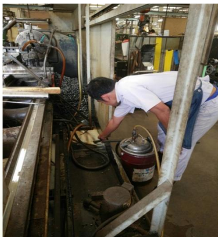
การนำน้ำมันตัดเหล็กผสมน้ำกลับมาใช้ใหม่ (หลังการดำเนินการแผนงาน)
