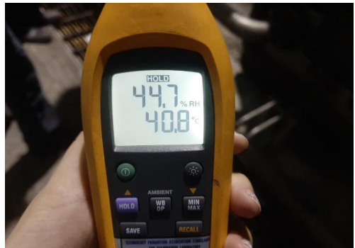
การตรวจวัดอุณหภูมิอากาศเข้าเครื่องอัดอากาศ และบริเวณโดยรอบของห้อง
