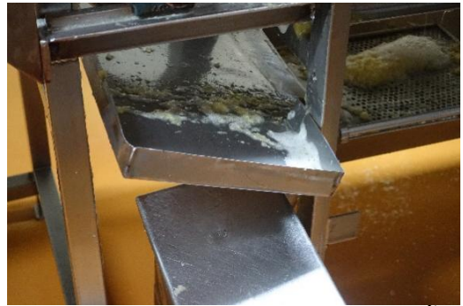
ทำปึกกันตกและถาดรองรับสินค้ามีขนาดใหญ่ขึ้น
