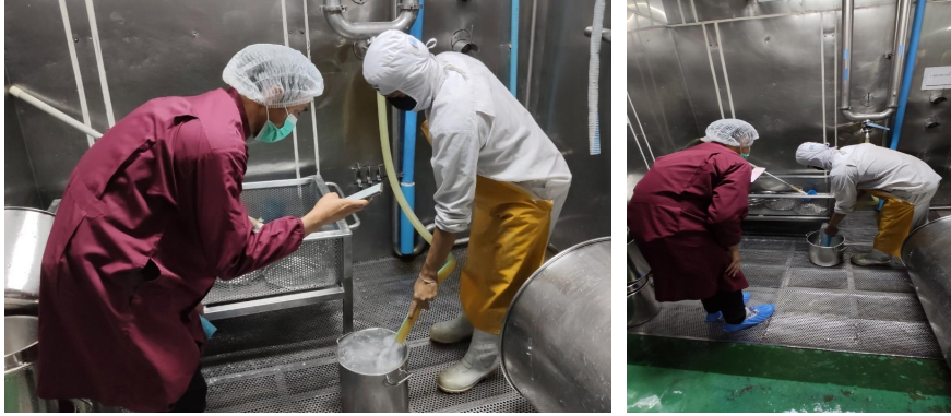
การตรวจวัดหาปริมาณน้ำที่ใช้ล้างถัง
